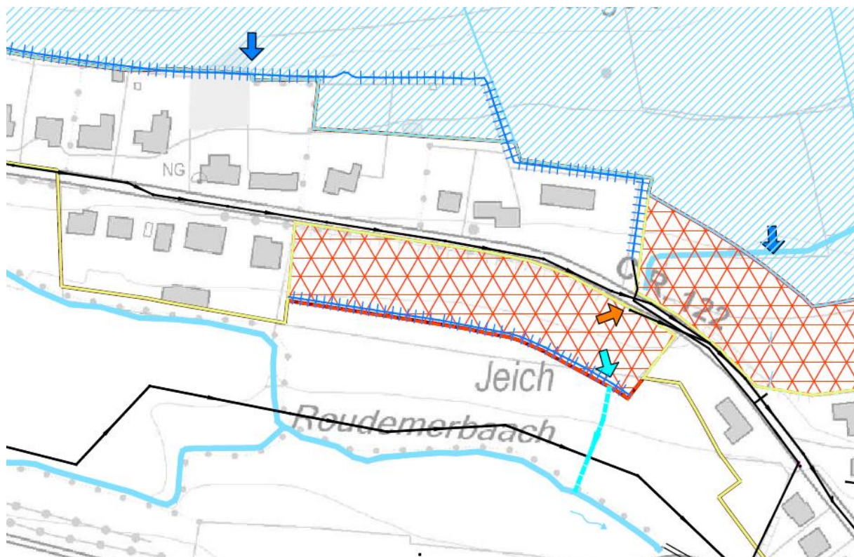
Extrait: Darstellung der möglichen RW-Achsen sowie Vorplanung der Kanal- und MW-Behandlung, BEST, 19.05.2017 – Der gesamte Plan mit Legende ist dem Teil 1 der étude préparatoire beigefügt.
